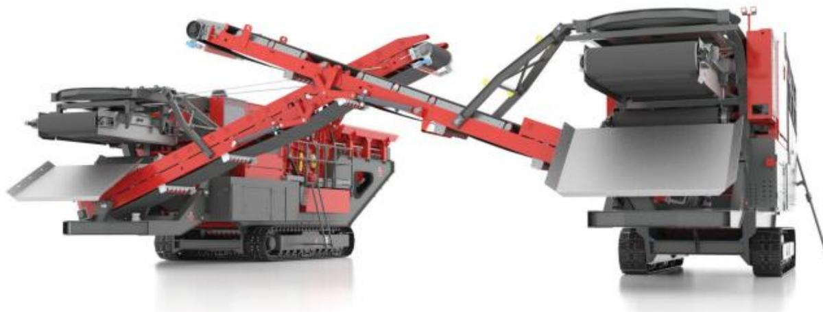
Le concasseur à percussion mobile GIPO P 131 ML DB (ML= Séparateur magnétique longitudinale, DB = Bande pivotante) est conçu pour traiter du béton fortement armé.
